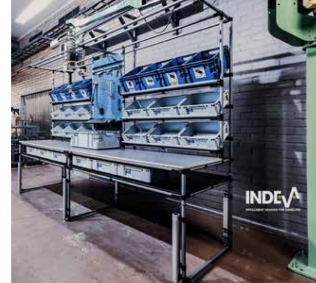
In deze toepassing wordt een INDEVA-manipulator gecombineerd met een modulair werkstation met geïntegreerde toolwand en in de hoogte verstelbare poten.
