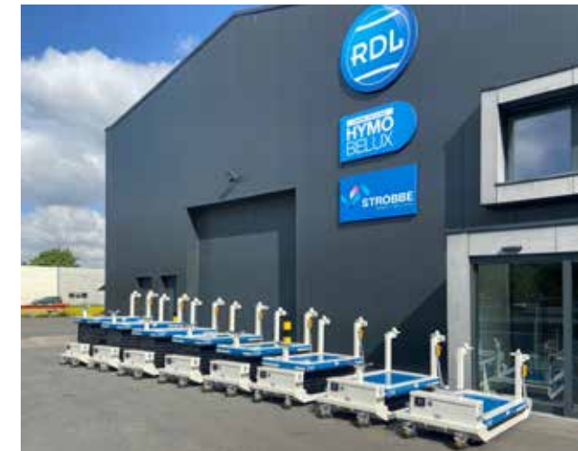
Een set op maat gemaakte mobiele heftafels voor een klant uit de automotive. Ze staan volledig op zichzelf en worden met batterijpakketten aangestuurd. Ze kunnen nu 900 kg heffen, maar kunnen verder uitgebouwd worden voor zwaardere lasten.
