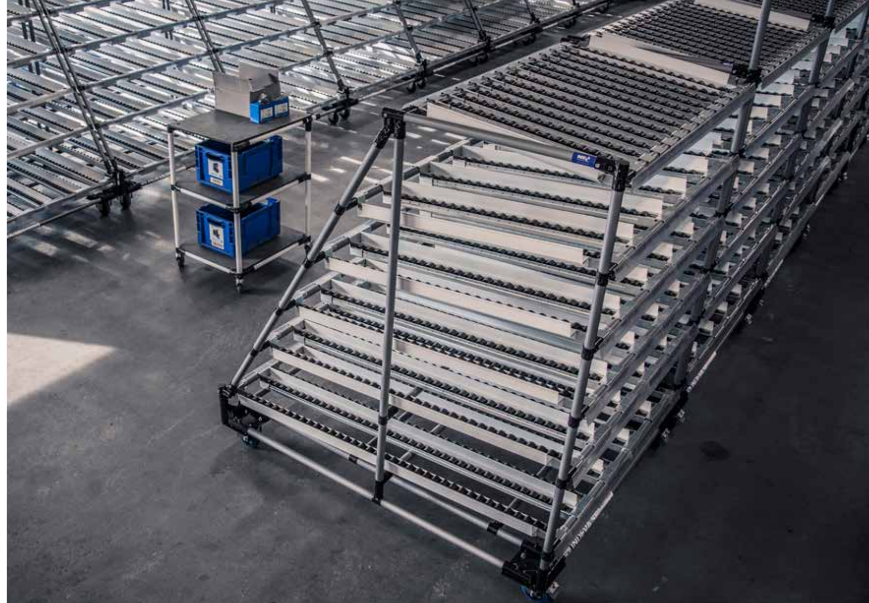
Een modulaire opbouw van een logistiek werkcenter waar kits gemaakt worden.
