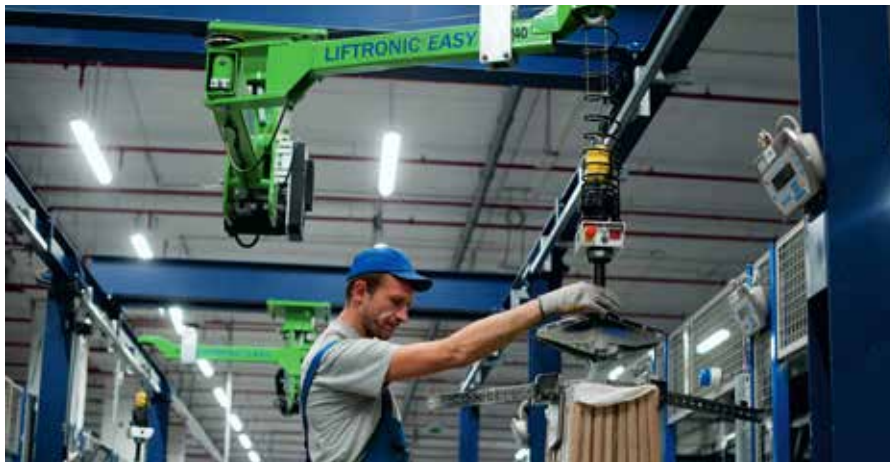
Zware tegelpakketten tillen met een industriële INDEVA-manipulator: in vergelijking met een manuele handling voelt de operator slechts een fractie van het gewicht.
